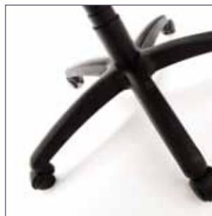
Base étoile en nylon renforcée de 30% de fibre de verre ou moulée en aluminium poli pour un support longue durée. Moyeu de base renforcé par un anneau de métal pour assurer que le cylindre soit solidement fixé en place.
