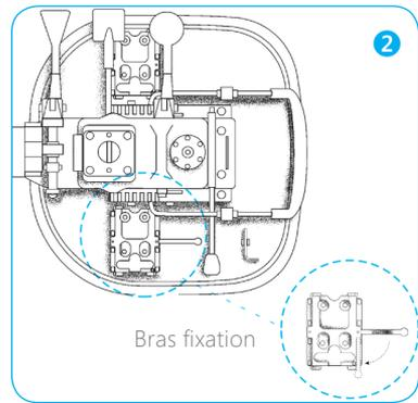
Voir la fixation de bras avec réglage en largeur sous le siège. Boucher le levier pour débloquer la position (voir le diagramme 4).
