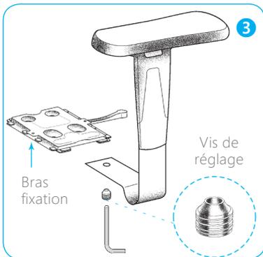
Insérez le bras en le glissant dans la fixation. Assurez-vous de placer les filets de la vis de réglage vers le haut. Vissez bien serré dans l'orifice situé dans le bras à l'aide de la clé hexagonale.
