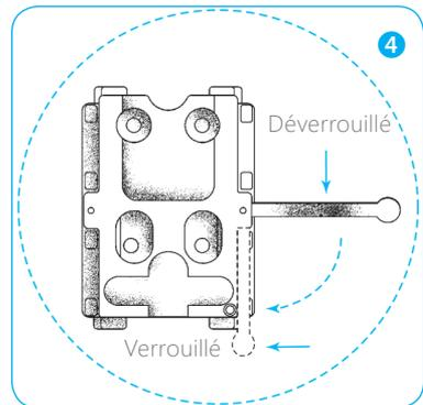
Remettez la clé hexagonale dans sa fixation. Réglez le bras à la largeur désirée et verrouillez-le en position.
