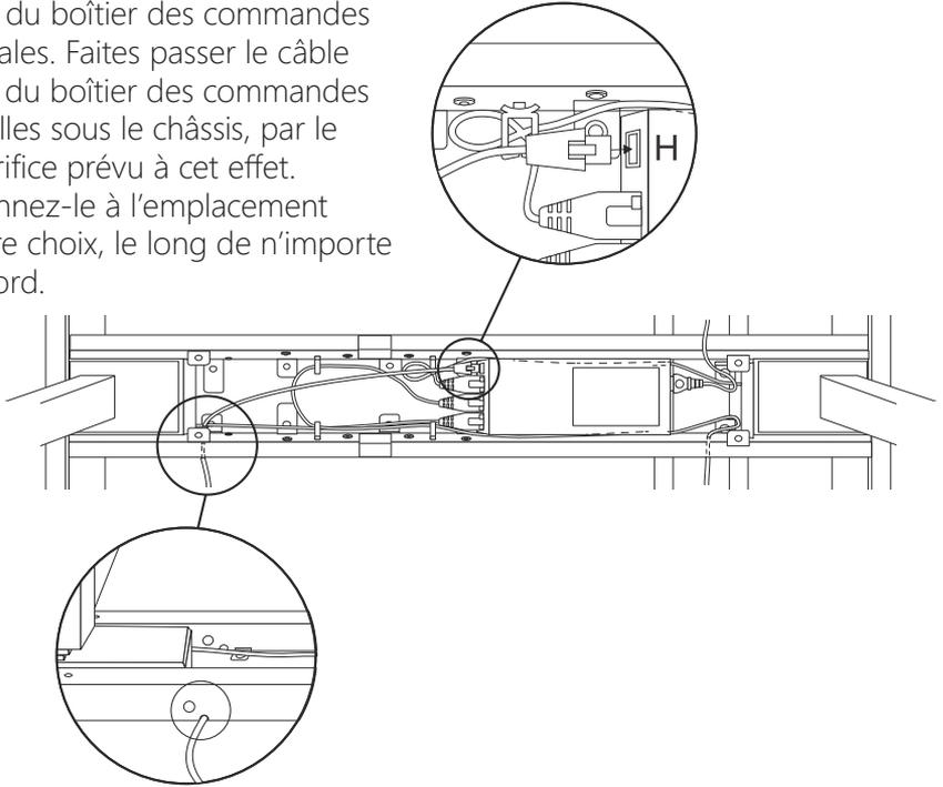
**Étape 12:** Assurez-vous qu'aucun fil n'est coincé entre le châssis et la surface de travail, puis fixez le châssis au plateau à l'aide de 24 vis à bois (**B**), en veillant chaque fois à vous aligner aux orifices de montage.
