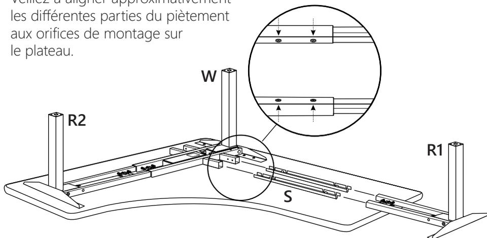
**Étape 9:** Positionnez l'ensemble de sorte que les 3 montants (**M**) soient tous alignés aux orifices de montage sur le plateau. Serrez ensuite toutes les vis de réglage (**C**) destinées à fixer les barres intérieures de renfort.
