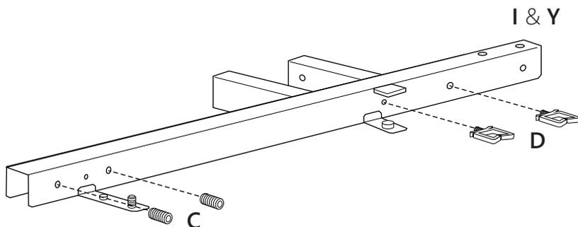
**Étape 2:** Fixez les montants (I) et (Y) du piètement central au pied central (Q) à l'aide de 2 vis à tête creuse (F).
