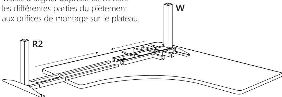
**Remarque:** Si la dimension du plateau est inférieure à 55 po, passez l'étape 8 et n'utilisez pas les barres intérieures de renfort (S).
