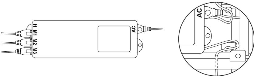
**Étape 11:** Raccordez le boîtier des commandes manuelles (**L**) au port **H** du boîtier des commandes principales. Faites passer le câble venant du boîtier des commandes manuelles sous le châssis, par le petit orifice prévu à cet effet. Positionnez-le à l'emplacement de votre choix, le long de n'importe quel bord.
