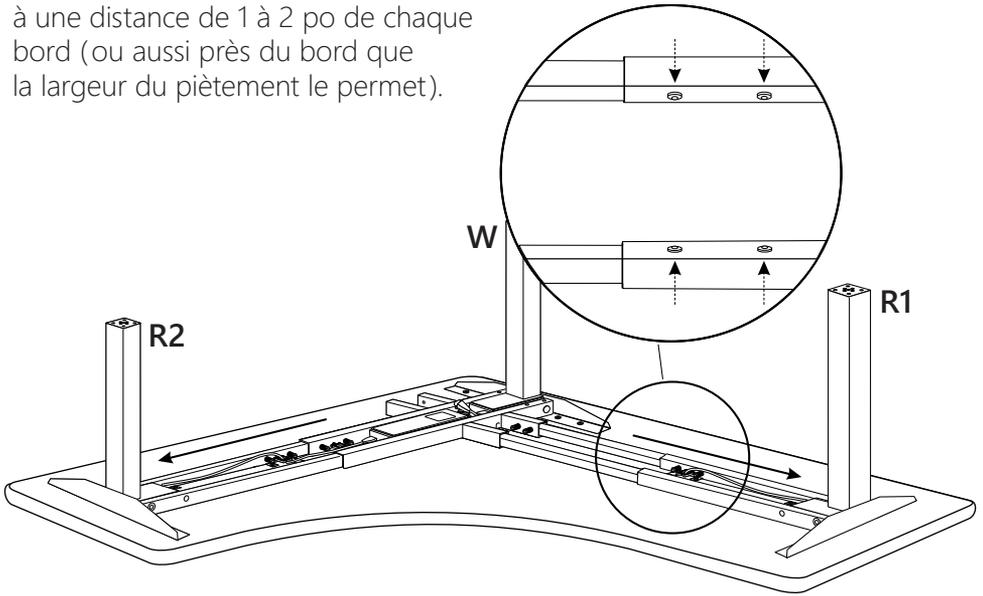
**Étape 10:** Faites passer les fils venant des 3 pieds au centre du châssis pour les raccorder aux ports **M1**, **M2** et **M3**. Veillez à faire passer le fil venant de (**R1**) sous le châssis, par le petit orifice prévu à cet effet. Notez qu'il se peut que le fil ne soit pas assez long pour atteindre le boîtier des commandes principales. Dans ce cas, utilisez le câble de rallonge (**Z**).
