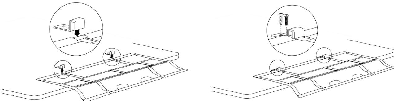
**Étape 2 :** Placez les supports ouverts (D) sur le plan de travail, alignés avec les supports fixes fermés. Fixez les supports sur le plan de travail à l'aide de vis à bois (B).
